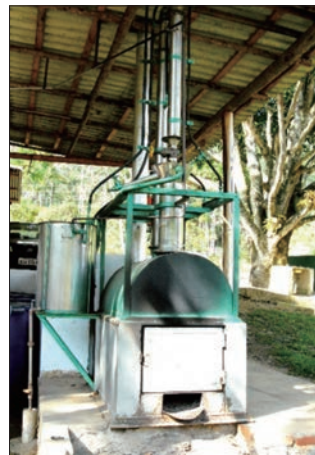
小型バイオエタノール蒸留装置 (ピソーザ連邦大学のジュアレ博士所有の研究農場)
