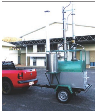
小型バイオエタノール蒸留装置(移動式) (ピソーザ連邦大学のジュアレ博士の実証実験)
